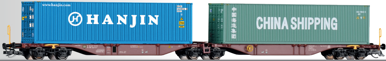
Containertragwagen Sggmrss der SNCB, beladen mit zwei 40'-Containern Container car Sggmrss of the SNCB with load
