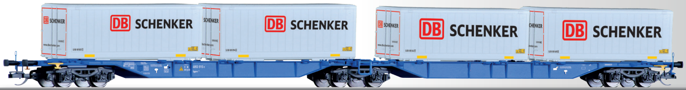
Doppeltragwagen Sggmrs 714 der DB AG, beladen mit vier Wechselbehältern DB Schenker Container car Sggmrs 714 of the DB AG with load • Mit freundlicher Unterstützung / Licensed by DB Schenker AG
