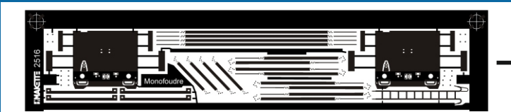
2516 Zurüstsatz „Weinfasswagen“ für Jouef-Weinfasswagen, Umbau in „Einzelfass-Wagen“ Détailage „wagon monofoudre“ sur base Jouef Bi-Foudre, laiton photogravé
